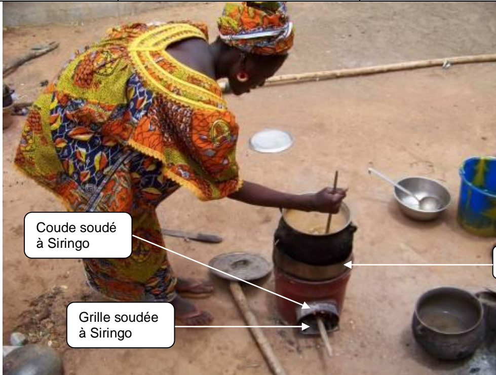
Ce petit fourneau reste chez les Coulibaly. Le suivi permettra d'évaluer la durabilité de la tôle et de la soudure.
