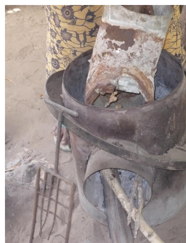
Fourneau en très mauvais état : coude rouillé, grille et support de casserole troués
